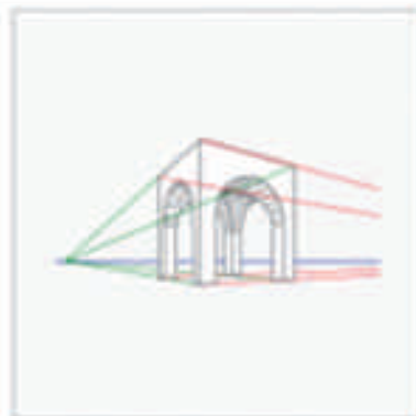
Perspectiva de dois pontos de fuga
